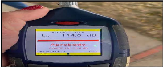
Foto No.5 Calibración de los equipos.
